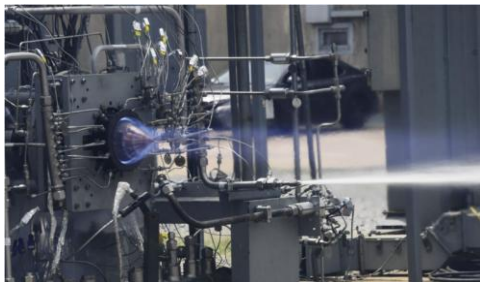
شکل ۴- تصویری از آزمایش گرم موتور انفجار چرخشی در مرکز فضایی مارشال ناسا [39]
