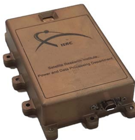
شکل (۳): نمایی از محموله تشعشعی (دزیتر)
