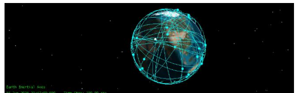
شکل (۱۲): طراحی منظومه ماهواره‌ای ناوبری بر اساس دسترسی چهار ماهواره و تعدیل هندسی دقت در نرم‌افزار STK
