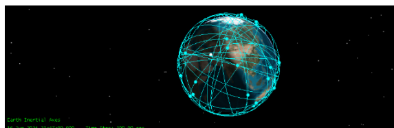
شکل (۱۲): طراحی منظومه ماهواره‌ای ناوبری بر اساس دسترسی چهار ماهواره و تعدیل هندسی دقت در نرم‌افزار STK
