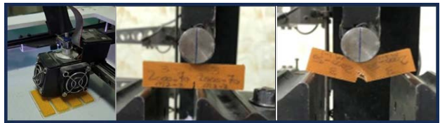
شکل (۲) فرایند ساخت و آزمایش شکست قطعات تولید شده با
