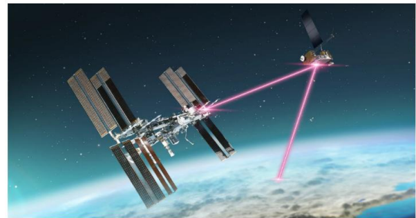
شکل (۲۱): نمای مفهومی ارتباط رله بین ILLUMA-T و ایستگاه زمینی [193].
