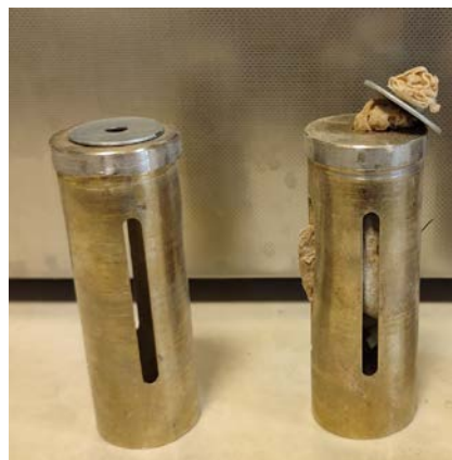
شکل ۱. سازه فلزی طراحی شده برای تعبیه درون کپسول زیستی (تصویر سمت چپ) و نحوه قرار دادن بذرها درون آن (سمت راست).
