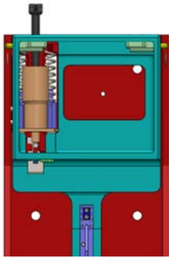
شکل (۹): محل قرار گیری مکانیزم قفل و رهایش در قسمت ۱
