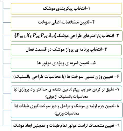
شکل (۱): گامهای طراحی جسم پرنده به روش الگوریتم سرعت لازمه [11]
