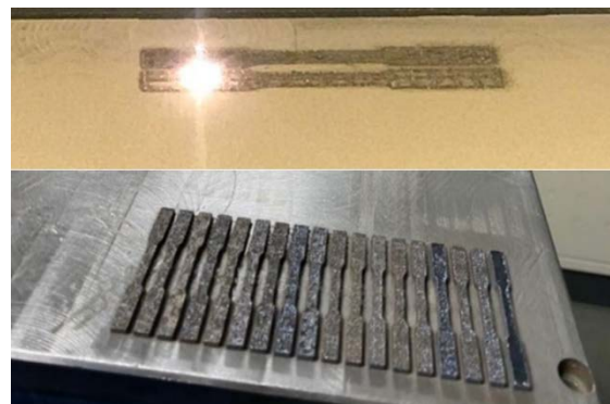
شکل (۳): فرآیند ساخت افزایش نمونه‌های کشش
