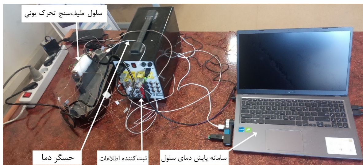
شکل (۳): تجهیزات مورد استفاده در بررسی تجربی عملکرد حرارتی
