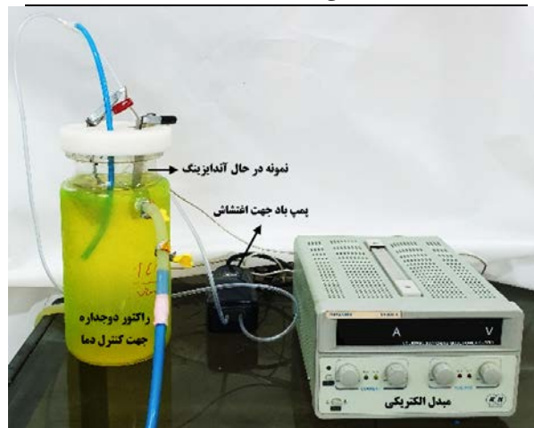
شکل (۲): تجهیزات فرایند آندایزینگ
