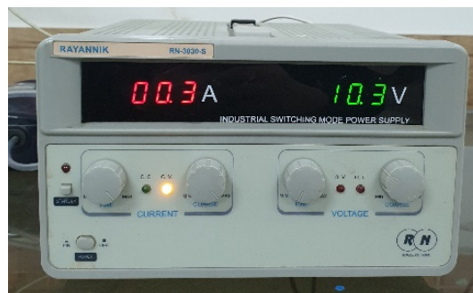
شکل (۱): مبدل الکتریکی مورد استفاده در آندایزینگ
