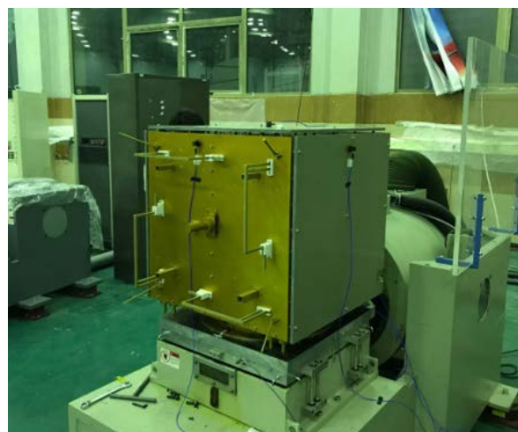
شکل (۱۳): نمایی از ماهواره مورد بررسی بر روی شیکر برای انجام آزمون‌های مکانیکی
