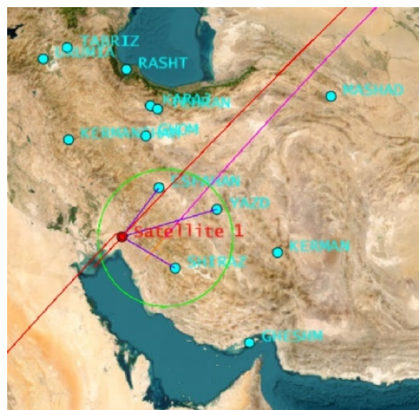
شکل ۶. شبیه‌سازی مدار حرکتی ماهواره و محاسبه قابلیت دسترسی ماهواره به اهداف رصدی
