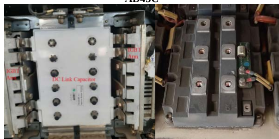
شکل ۸. کلید قدرت IGBT و خازن لینک DC
