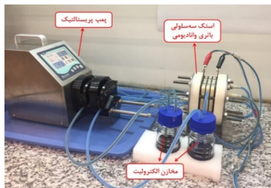
شکل ۲. چینش آزمون برای باتری جریان‌ی وانادیومی
