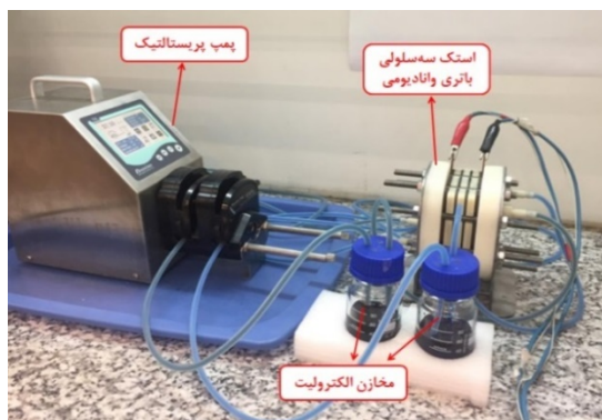
شکل ۲. چینش آزمون برای باتری جریان‌ی وانادیومی
