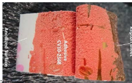
۱۲. کندگی نوع شکست هم‌چسبی در چسب CV10-2568 آماده‌سازی شده به روش A-P-H-P
