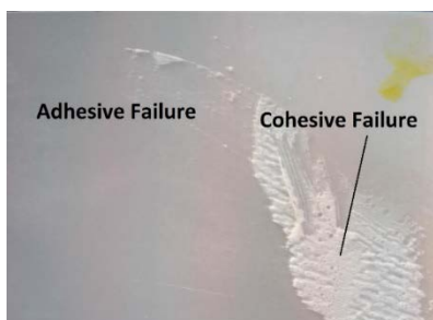
شکل ۱۰. کندگی نوع شکست هم‌چسبی و شکست چسبی در چسب CV-2289 آماده‌سازی شده به روش S-A-P-H-P
