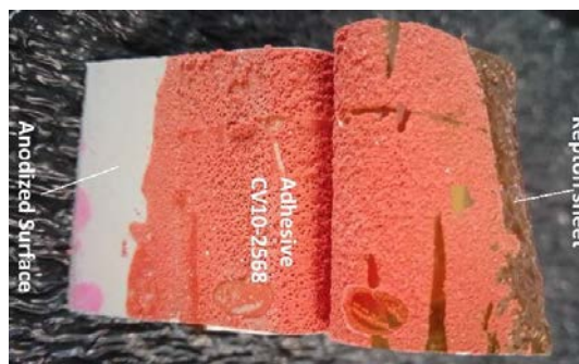
شکل ۱۲. کندگی نوع شکست هم‌چسبی در چسب CV10-2568 آماده‌سازی شده به روش A-P-H-P
