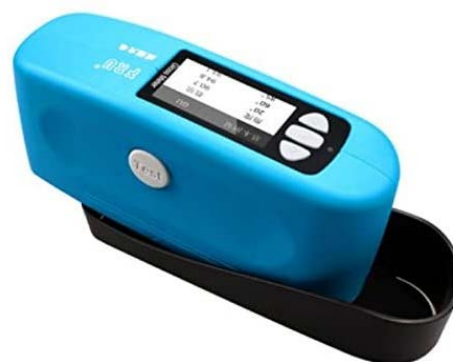
شکل ۵. براقیات‌سنج مدل WG68 با توانایی اندازه‌گیری سه زاویه ۲۰، ۶۰ و ۸۵ درجه
