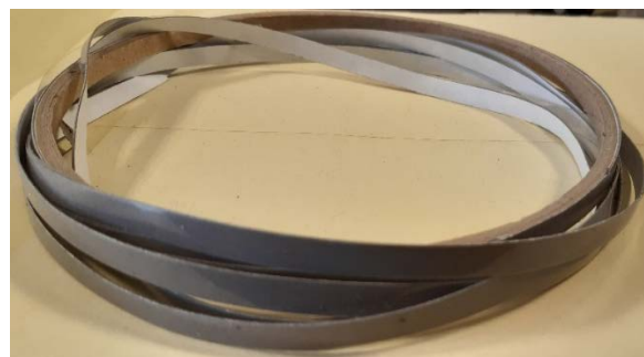
شکل ۲. نوار تهیه شده از ماده پُرکننده پایه نیکل BNi2
