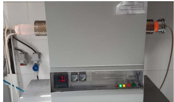
شکل ۴. کوره مدل یاران تحت گاز آرگون
