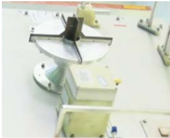
شکل (۸). نمایی از آنتن ساخته شده نصب شده بر روی صفحه آنتن ماهواره.
