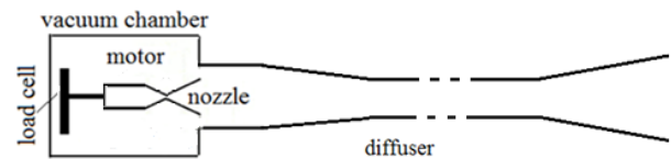
شکل ۱. شماتیک هسته مرکزی بستر شبیه‌ساز ارتفاع بالا [۱]
