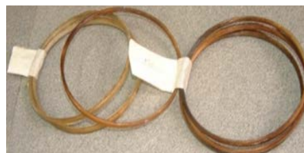
شکل ۴. حلقه های NOL ساخته شده
