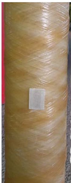
شکل ۱۸. صفحه تراز چسبانیده شده برای بالا بردن دقت اندازه-
