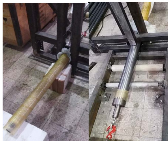
شکل ۱۳. خروج نمونه از مندرل و نمایی از ریل کشنده
