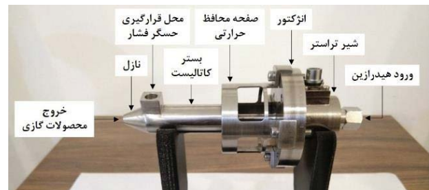
شکل ۲. تصویری از تراستر تک پیشراانه هیدرازینی
