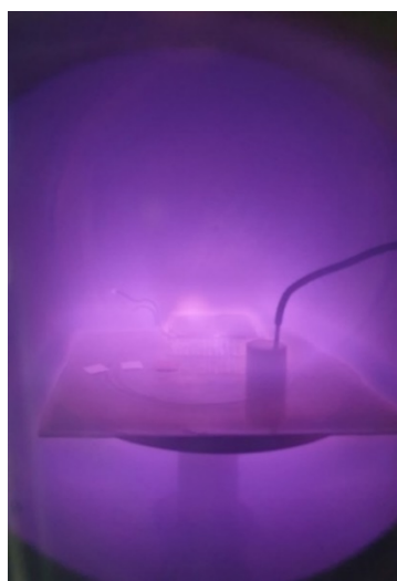
شکل ۴. نمونه‌های آزمایشگاهی قرار گرفته در محیط تجهیز پلاسمای DC
