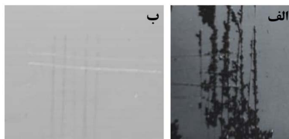
شکل ۵. سطح اثر کراس کات الف- نمونه دارای پوشش کروم، ب- پوشش کروم نیتروژن‌دهی پلاسمایی شده
